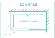
CONTROLS MAY BE POSITIONED ON THE FRONT AND BACK CORNER
